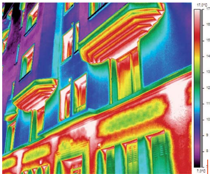
Fuites thermiques constatées sous les oriel, Paris 19 e
